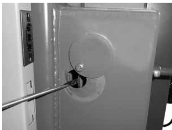
Kontrola i oczyszczanie regulatora proporcji powietrza pierwotnego i wtórnego poprzez otwór techniczny
