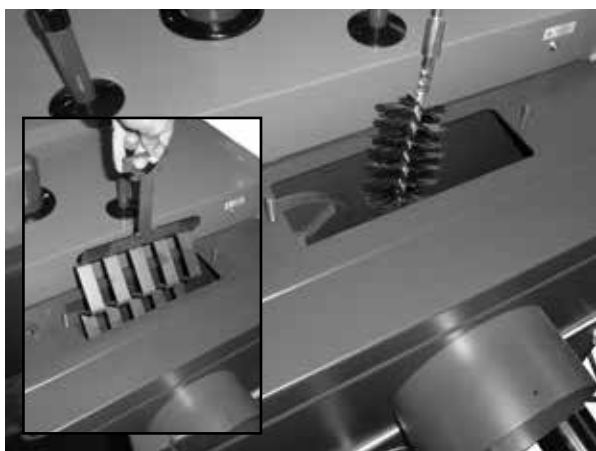
Czyszczenie pionowego kanału spalinowego poprzez wieczko górne przy pomocy szczotki. Podczas czyszczenia wyjmij zwalnicze z kanału dymowego.
