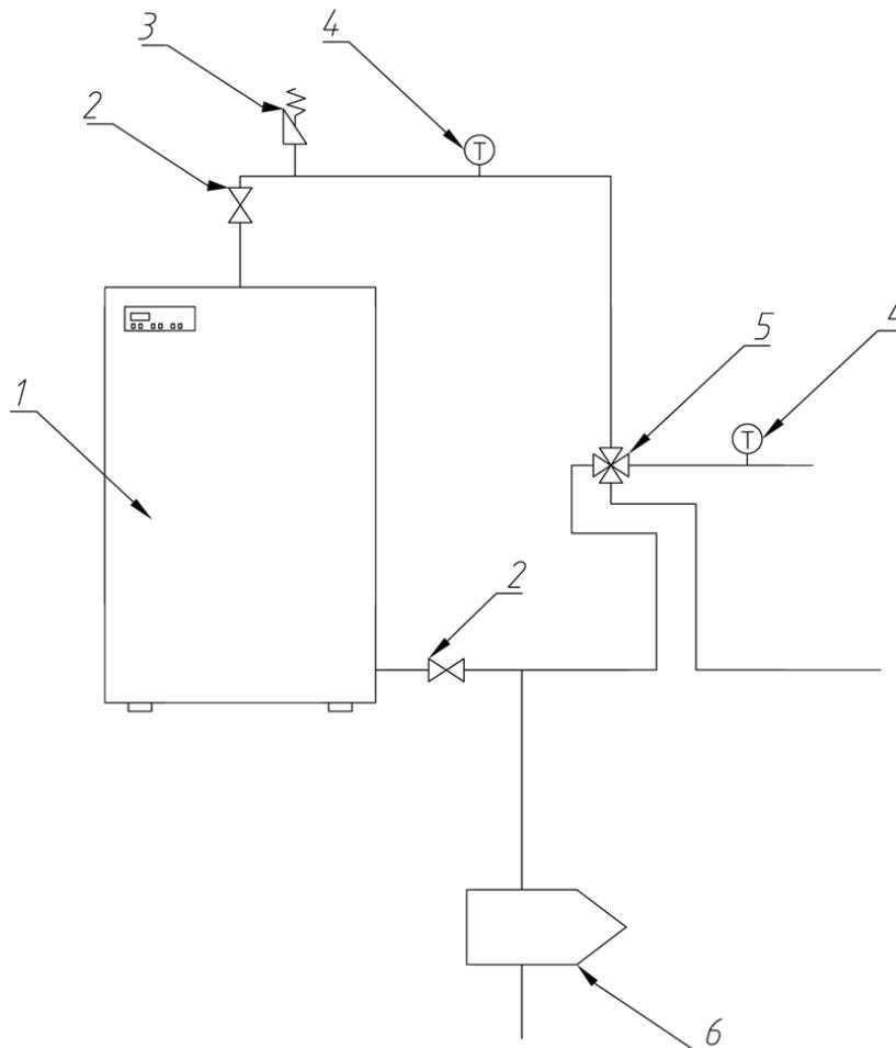
1) Boiler 2) Boiler valve 3) Automatic air vent 4) Thermo-manometer 5) Mix valve 6) Dirt catcher
