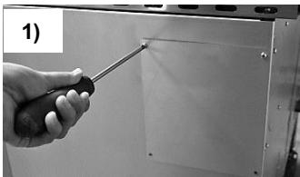
1) Zdejmij zewnętrzną pokrywę ochronną za pomocą śrubokręta
