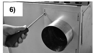
6) Zamontować zewnętrzną blachę ochronną, używając śrub użytych wcześniej do zamocowania zewnętrznej pokrywy ochronnej.
